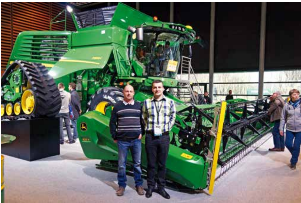
Nicolas Deville du groupe Haag et Laurent Bourgeois devant la moissonneuse-batteuse John Deere T560 à système de battage tangentiel (mise à jour 2016). Le débit de chantier est augmenté, la paille préservée, grâce à des composants surdimensionnés par rapport aux anciennes versions. L'engin est équipé du GPS autotrack et de la cartographie de rendements ainsi que de capteurs d'humidité. © Ilona Bonjean
