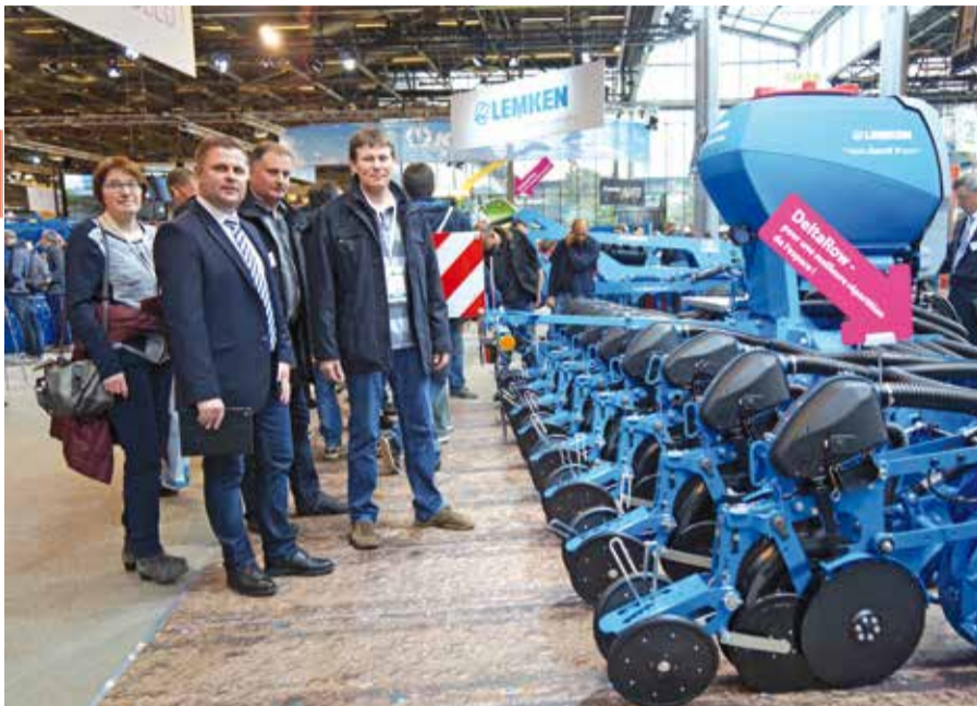
Nicolas Soehnen, inspecteur commercial Lemken pour l'est de la France, présente à des clients potentiels le nouveau semoir à maïs Azurit 9, dont des prototypes ont déjà tourné en Alsace. Ce semoir sème un double rang écarté de 12,5 cm avec un rang d'engrais en milieu. Différentes versions sont disponibles : en mode solo avec trémie frontale ou en version combinée avec le nouveau semoir Solitaire 25. © Ilona Bonjean
