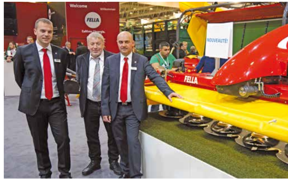
Pierre Tesson, Jean-Paul Huckel et Olivier Viriot devant la faucheuse frontale Fella Ramos 3060 dont le design a été révisité. Ses caractéristiques : 3 m de large, 6 assiettes dont 4 ventilées et des bâches extérieures à repliage hydraulique. Disponible seule à la vente, elle est également commercialisée en combiné avec le Ramos 9314 TL-KCB. © Ilona Bonjean
