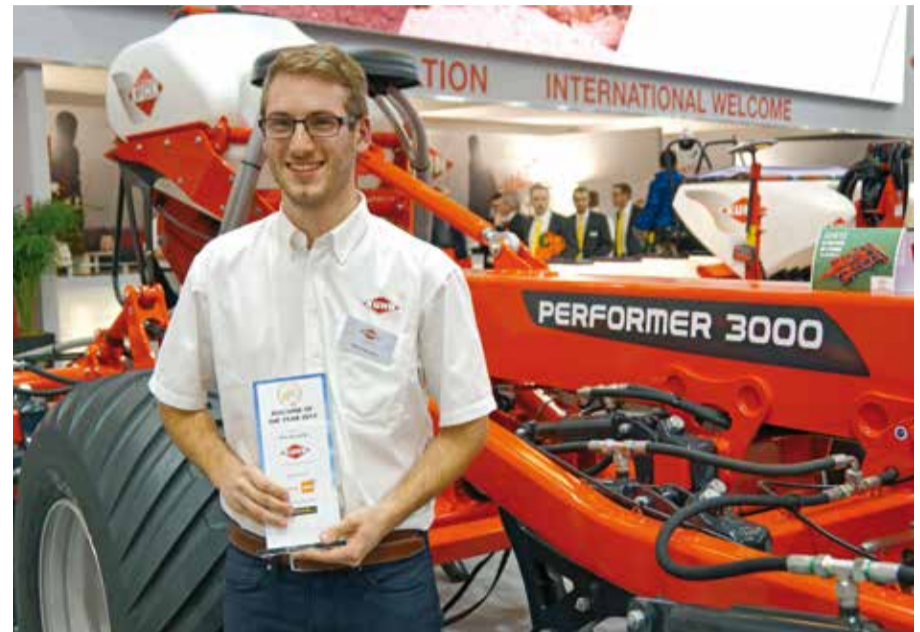
Pierre Reymann, responsable produit Kuhn en Loire-Atlantique, présente le Performer 3000. Cet outil One pass a remporté le vote du public pour la machine de l'année. Deux rangées de disques viennent d'abord découper les résidus, avant que quatre rangées de dents fissent le sol sur 35 cm avant qu'il soit rappuyé par un rouleau. Cet outil, de 3 m de large et 11 m de long, pèse 3,8 t. © Ilona Bonjean
