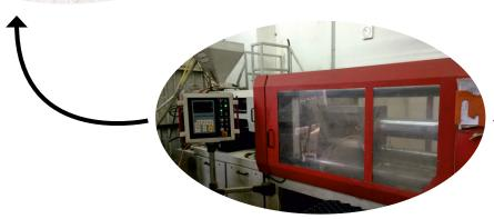
Transformation du granulé Par injection, intrusion et pesage
