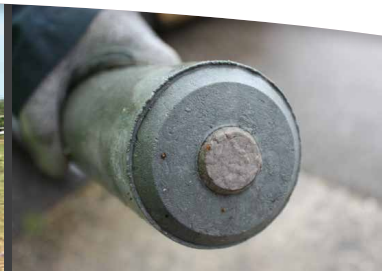
Armature métallique ST 37 - Ø 26,9 x 2 mm
