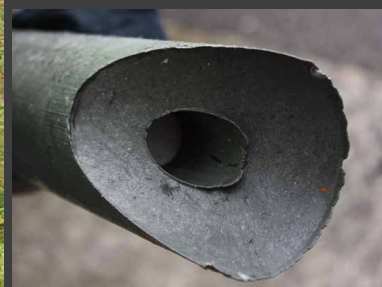
Jambe de force avec armature métallique
