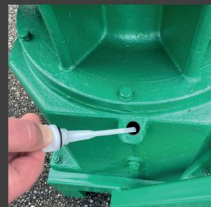
Bouchon de graissage
