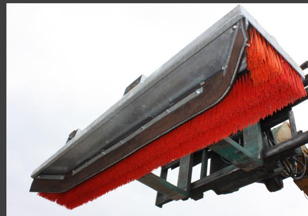
Bande caoutchouc et brosse avec rebords : permet d'amasser les débris et de ne pas en répandre sur les côtés
