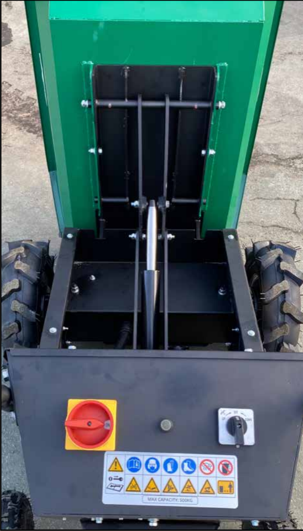
Bouton marche-arrêt, sélecteur de vitesse et vérin hydraulique en action
