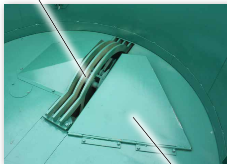
Sabot releveur actionné par vérin hydraulique (évite le bourrage et facilite le démarrage)
