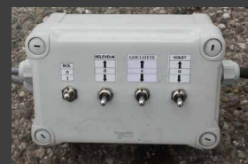
Boîtier de commande électro-hydraulique de rotation du bol, du sabot releveur et du bec déflecteur
