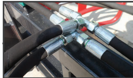
Raccord hydraulique en T (branchement par 2 prises d'huile hydraulique)
