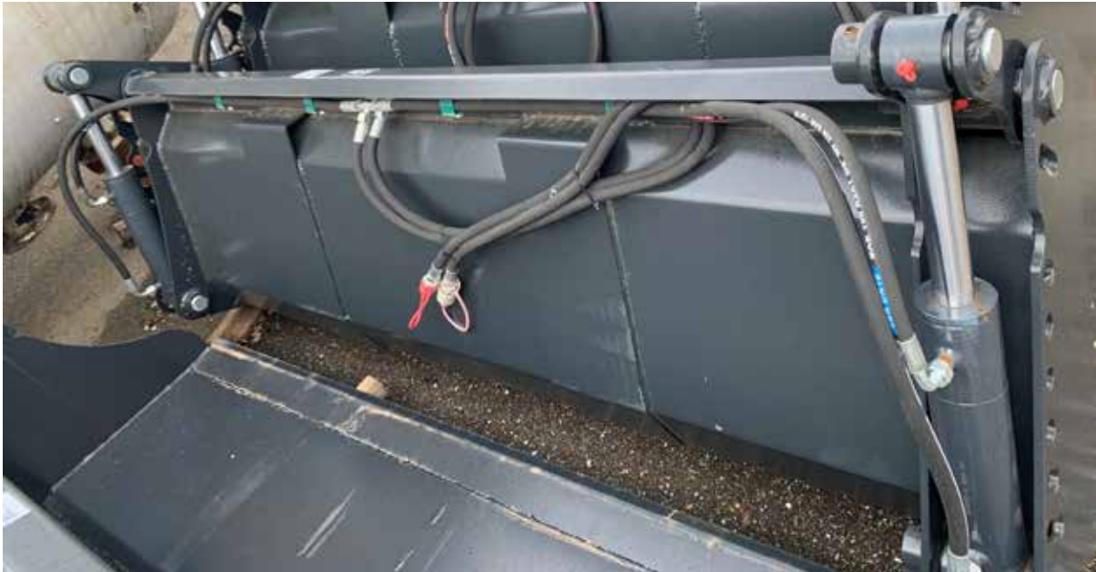
Vérins hydrauliques sur l'arrière du godet
