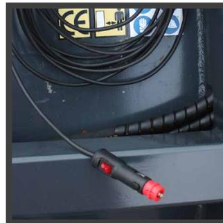
> Branchement allume-cigare. Fonctionnement : électrovanne, basculement malaxage/trappe de vidange hydraulique
