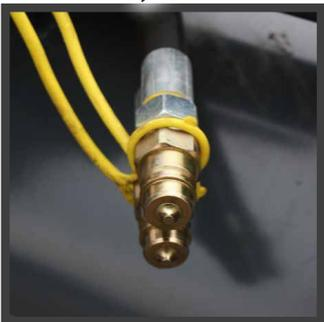
> Flexibles hydrauliques avec connecteurs mâles inclus
