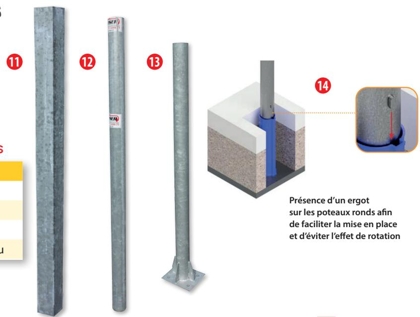
Présence d'un ergot sur les poteaux ronds afin de faciliter la mise en place et d'éviter l'effet de rotation
