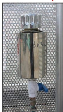
Réservoir avec lubrifiant pour tapis de de course
