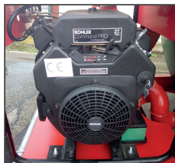
Moteur thermique 4 temps à démarrage électrique avec refroidissement par air
