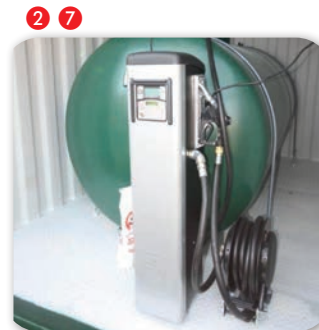
Distributeur à gestion intégré et plancher tôle
