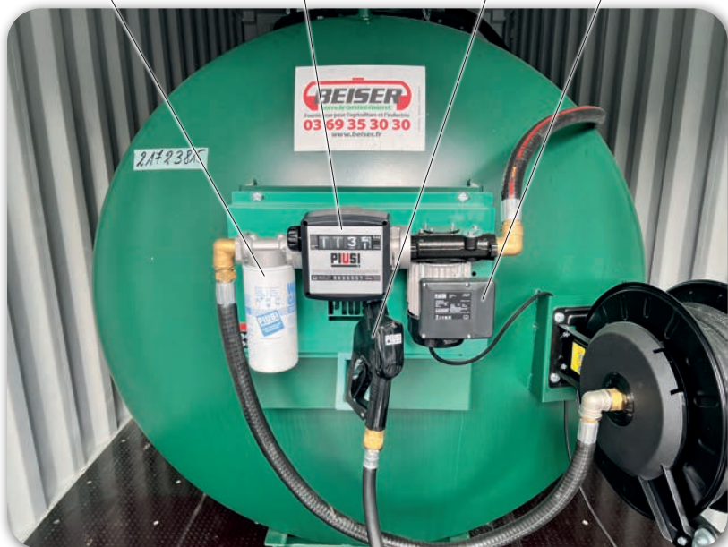
Filtre décanteur d'eau Compteur/totaliseur Pistolet automatique Pompe 60L/Min
