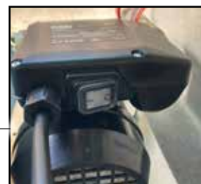
Interrupteur sur le dessous de la pompe
